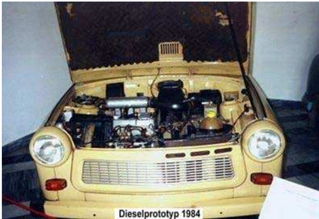
Versuch von 1984 mit einem Dieselmotor des Kleintransporters „Multicar“
