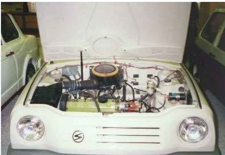
1,3 Liter-Motor von VW (Lizenzproduktion)
