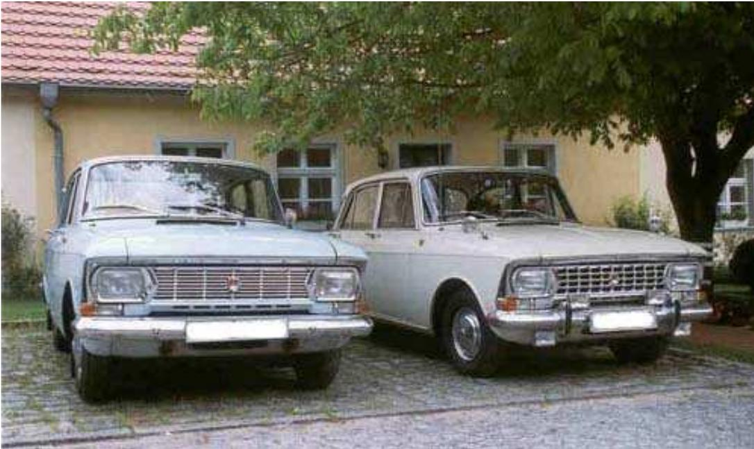
Der praktische Unterricht erfolgte Eingangs auf einem Fahrsimulator und dann auf einem Moskwitsch 412 (rechts) russischer Herkunft mit Viertaktmotor, Hinterrad-antrieb und sogar mit einer für DDR-PKW unüblichen Knüppelschaltung.
