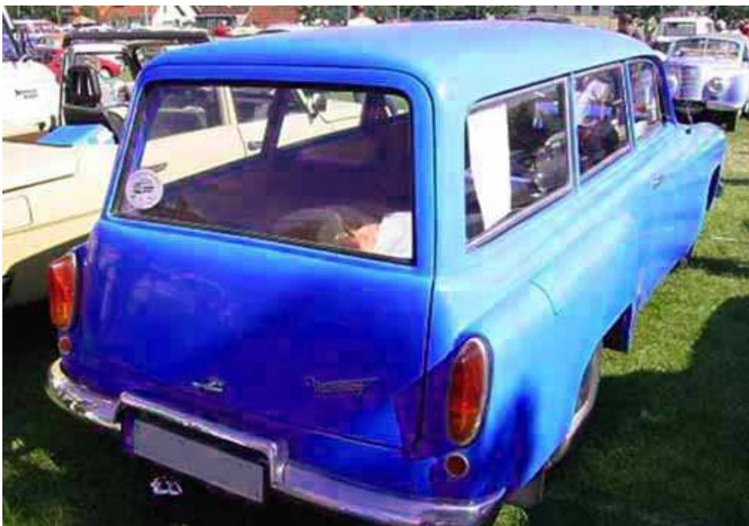
So sah unser Wartburg von hinten aus. Ausgerüstet mit einer druckgasgefederten Heckklappe, die wie später auch beim Wartburg 353 Tourist nach oben aufging. Zu erkennen im Bild, dass der Wartburg 312 Kombi ein 3-Türer mit großen Türen war.
