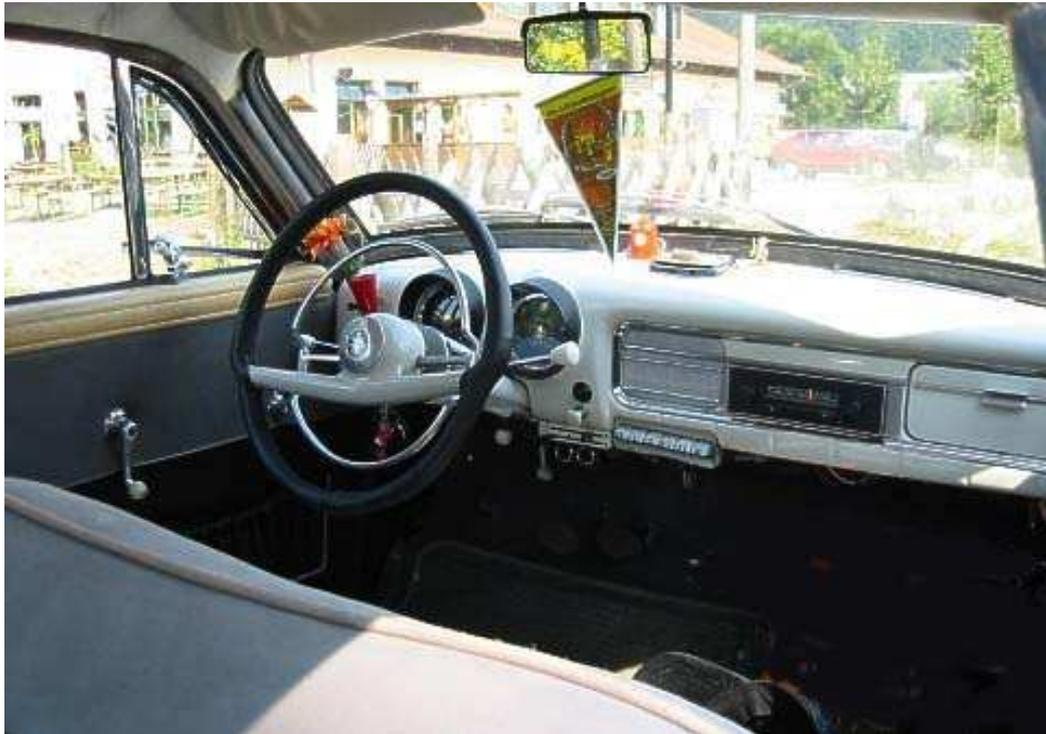
nur mit wenigen Bedienelementen, einem Hupring und Lenkradschaltung
